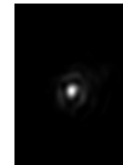
图11 独立子孔径形式样机共相前的远场像
